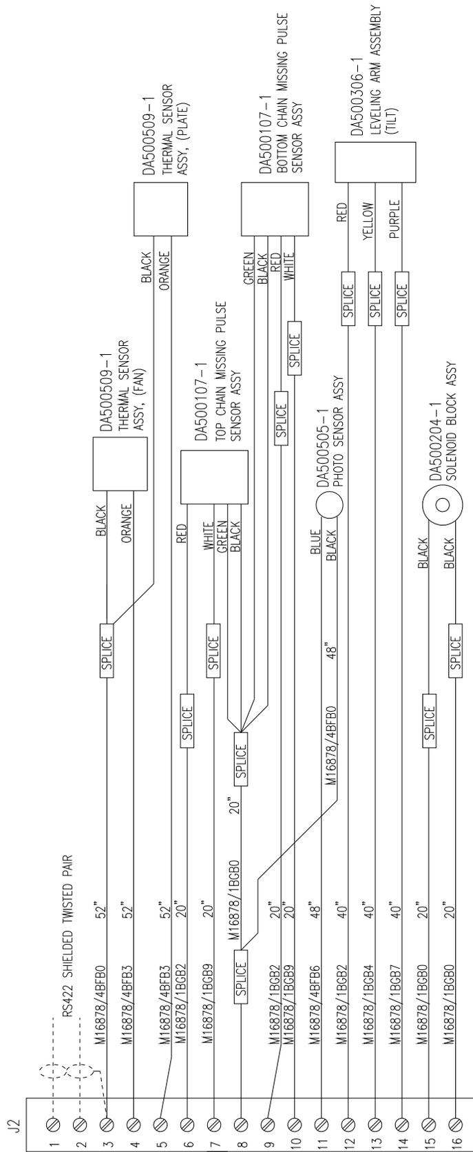
Figure 7b J2 Wiring Diagram
